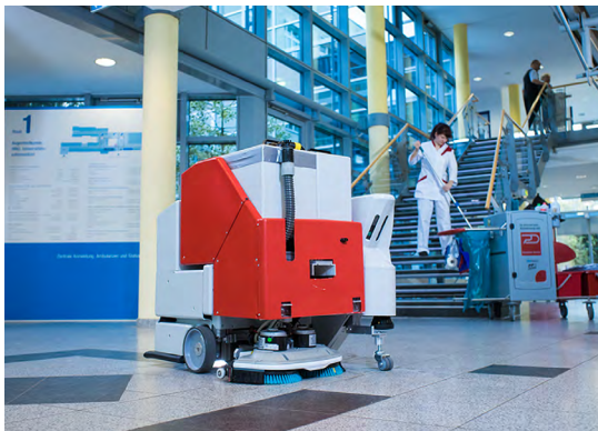
Der Reinigungsroboter mit Nassreinigungsmodule beim Praxistest in einem Krankenhaus.
