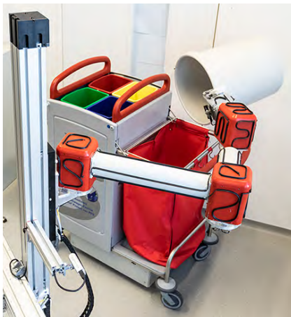
Der Roboterarm kann Papierkörbe selbstständig erkennen, greifen und den Inhalt in einen Sammelbehälter entleeren.
